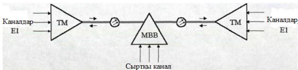
Сурет 1.7 - «Тізбектелген сызықтық тізбек» топологиясы, MVB - шығыс кіріс мультиплексоры
